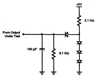
**Test Load Diagram**
