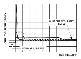
FIGURE 6. OC TO CR SETTLING TIME WAVEFORMS
