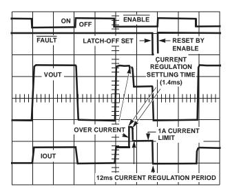
FIGURE 1. TYPICAL OPERATIONAL WAVEFORMS
