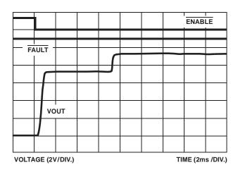
FIGURE 11. ISL6436L TURN-ON INTO 1.5A MOMENTARY OC
