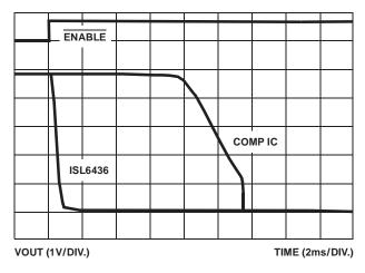
FIGURE 17. COMPARATIVE TURN-OFF WAVEFORMS
