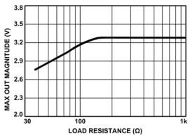
FIGURE 9. MAXIMUM OUTPUT vs LOAD RESISTANCE
