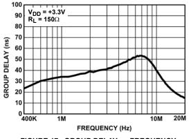
FIGURE 17. GROUP DELAY vs FREQUENCY
