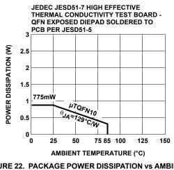
FIGURE 22. PACKAGE POWER DISSIPATION vs AMBIENT TEMPERATURE
